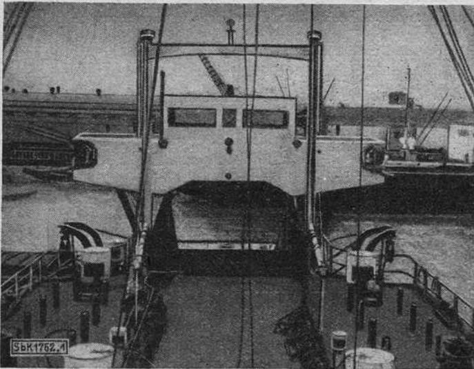
Bild 1. Hecköffnung der „Fairtry“ zum Aufholen des Spezialnetzes mit achterer Brücke
