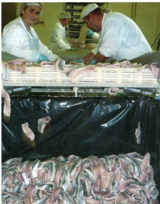
Befüllen von Lagertubs mit frischem Filet für die spätere Reifung in einem Garbad
